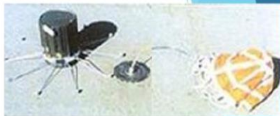
Протитанкова міна MN-121, Встановлюється дистанційним методом
