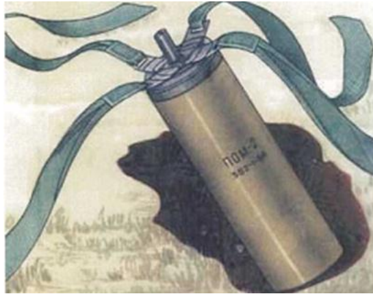
Рисунок 2.10.3 – міна ПОМ-2 в підкасетнику з капроновими стрічковими стабілізаторами.
