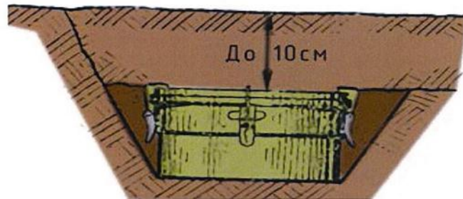
Рисунок 3.4.2 – встановлення міни МЛ-1 в ґрунті.
