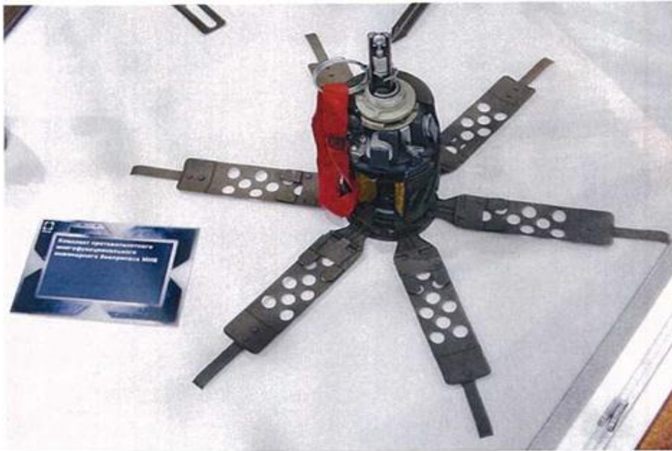
Рисунок 2.14.3 – міна-граната МИБ в бойовому положенні.
