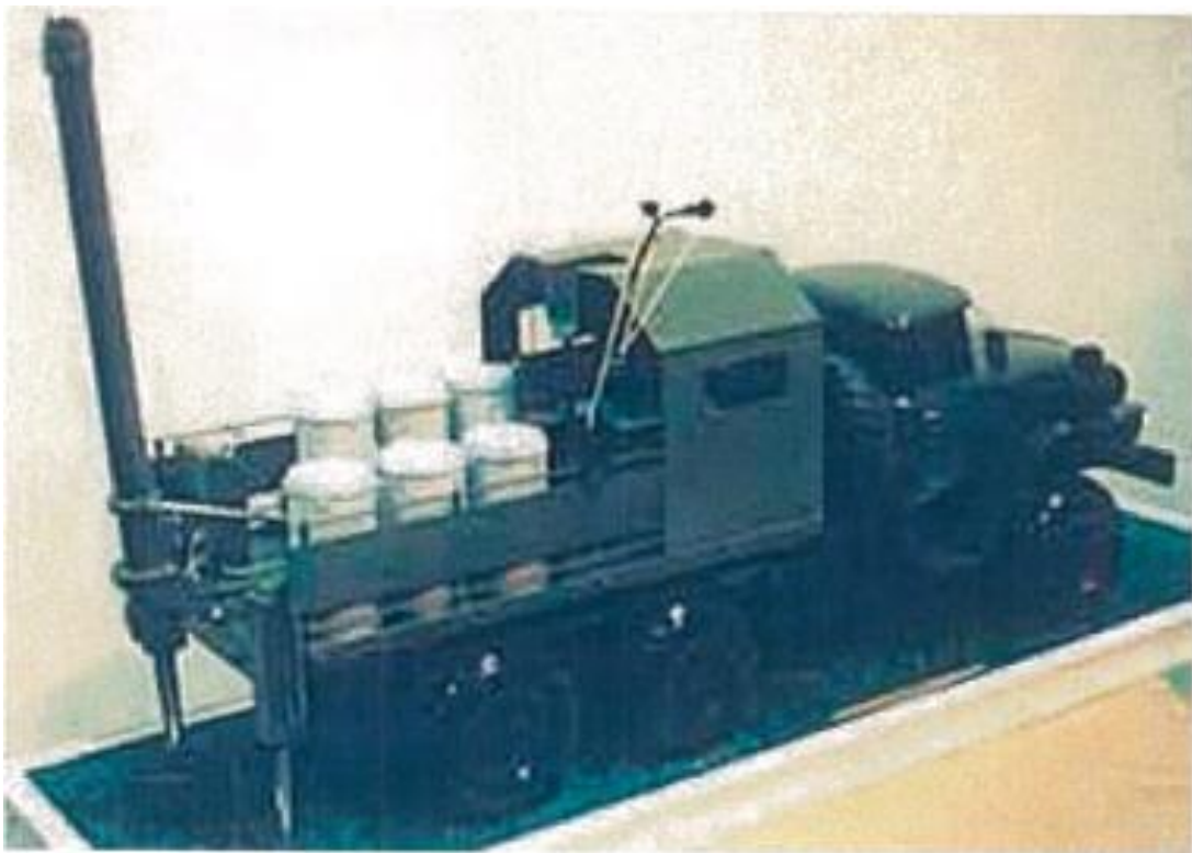
Рисунок 2.16.3 – розкладник мін М-225 на базі ЗІЛ-131 (макет).
