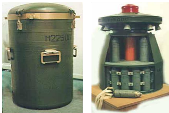
Рисунок 2.16.1 – міна М-225, загальний вигляд - зліва та в розрізі. Перед розрізом міни лежить вражаючий елемент.
