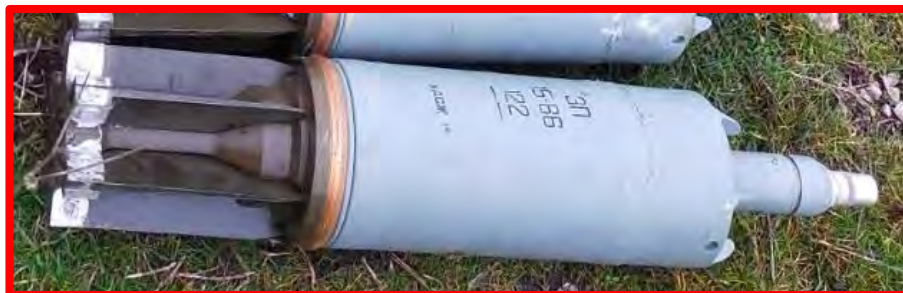
122 мм БК13 (кумулятивний) Довжина снаряда: 637 мм Примітка: використовує головний підрильник В-15. Країна походження: РФ
