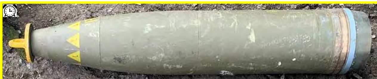
155 мм «M718» (кумулятивно-касетний) Довжина без підричника: 803 мм Довжина з підривником М557: 899 мм Країна походження: США
